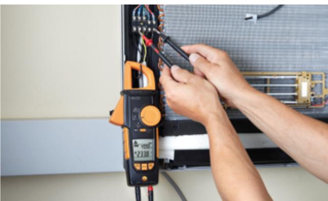
Spannungsmessung an einem Klimagerät mit **testo 770**.
