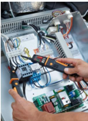
Spannungsmessung an einem Verdichter.
