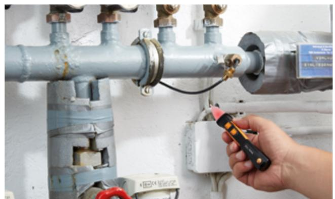
Spannungsüberprüfung an einer Verteilerdose mit **testo 745**.
