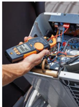
Einfädeln der Stromzange an einer Kälte-Außeneinheit.
