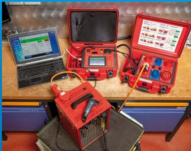
Prüfung eines 3-phasigen Heizlüfters
