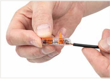
Die Klemmstelle öffnen und den Leiter einführen.
