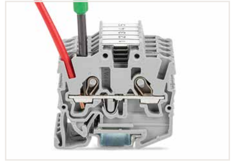
Lösen mit Betätigungswerkzeug – alle Leiter
