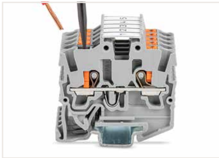
Leiter mit Betätigungswerkzeug anschließen – feindrähtige Leiter.
