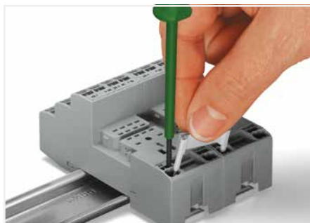
Brücker mit Schraubendreher lösen.
