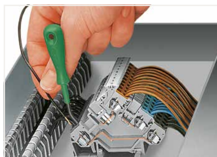
Das Betätigungswerkzeug eignet sich aufgrund der Klingenabmessungen gemäß DIN 5264 besonders für die Betätigung von Initiator- und Aktorenklemmen mit Frontverdrahtung der Serie 280.
