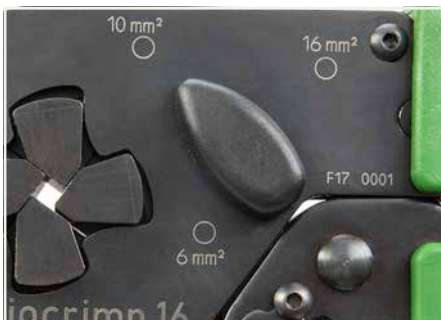
Nur für Variocrimp 16: Bei geöffneter Zange Leiterquerschnitt einstellen.
