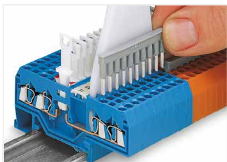
Brücken von Trennklennen mit Frontverdrahtung mit Brückungskämmen unter Zuhilfenahme eines 10-fach-Betätigungswerkzeuges
