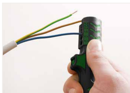
Abisolierung der Leiterisolation
