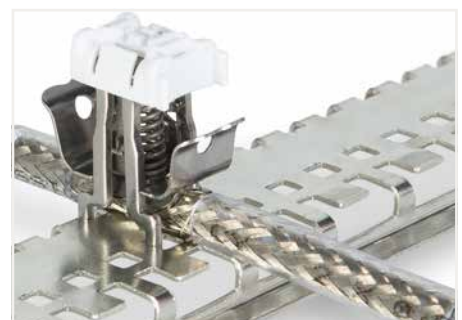
Schirmklemmbügel kontaktiert Schirmleiter und spezialgelochte Tragschiene (790-145).
