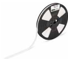
WMB-Inline; für Klemmenbreiten 5 ... 5,2 mm; unbedruckt; 1500 Schilder/Rolle; weiß
