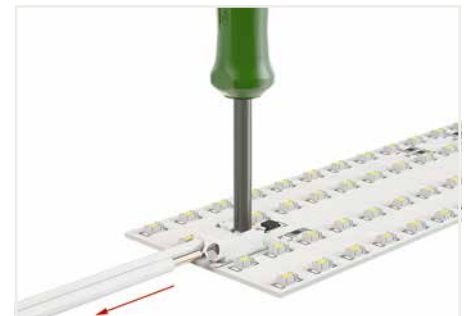
Feindrähtige Leiter anschließen und Leiter lösen – durch geringen Druck auf den Drücker, z. B. mit Betätigungswerkzeug 206-866.
