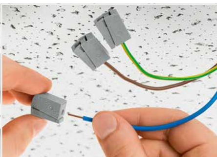
Leiter anschließen: Abisolierten eindrätigen Leiter bis zum Anschlag in die runde Öffnung hineinstecken.
