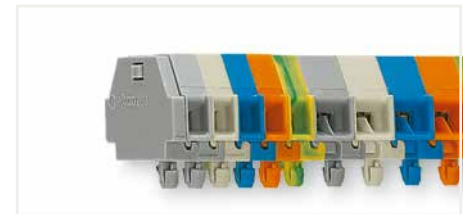
Klemmenleiste; mit Rastfüßen; für Blechdicke 0,6 ... 1,2 mm; Befestigungslöcher Ø 3,5 mm (auch für Aluminiumtragschiene (210-154) oder mit Montagefuß (209-120) für Tragschiene 35)
