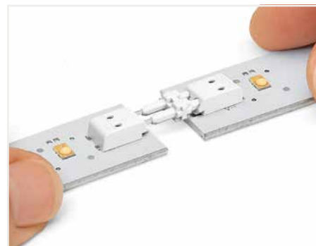
Leiterplatten verbinden/trennen – Leiterplatten auf einer ebenen Fläche positionieren und gerade (axial) ineinanderstecken und wieder herausziehen (max. 10 Steck-/Trennvorgänge).
