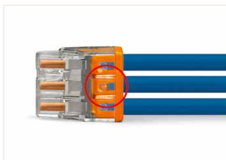
Leiteranschlag am Gehäuse und korrekte Abisolierlänge im farbigen Deckelsichtfenster visuell prüfen. Die korrekte Abisolierlänge ist eingehalten, wenn im farbigen Sichtfenster auf der unbedruckten Seite der Klemme kein blanker Leiter zu sehen ist. Im Bild ist der mittlere Leiter zu lang abisoliert.
