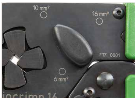
Nur für Variocrimp 16: Bei geöffneter Zange Leiterquerschnitt einstellen.
