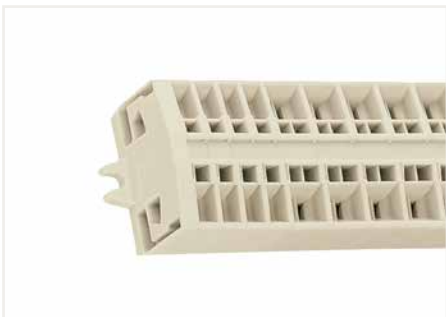
Klemmenleiste Ex e II; mit Befestigungsflanschen; für Schraub- u. ä. Befestigungsarten; Befestigungslöcher Ø 3,2 mm
