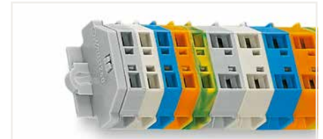
Klemmenleiste; mit Befestigungsflanschen; für Schraub- u. ä. Befestigungsarten; Befestigungslöcher Ø 3,2 mm (mit Montagefuß (209-123) auch für Tragschiene 35)
