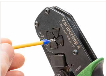
Leiter mit aufgesteckter Aderendhülse in die Crimp-Station einführen.
