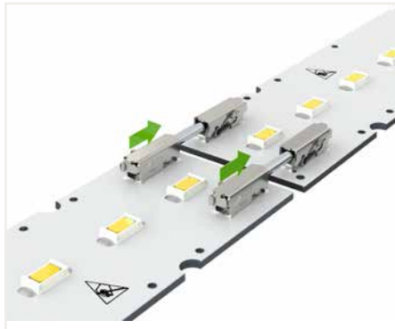
Leiterplatten verbinden/trennen – Leiterplatten auf einer ebenen Fläche positionieren und gerade (axial) ineinander stecken. Zum Trennen per Betätigungswerkzeug die Klemmen unterstützend öffnen (max. 5 Steck-/Trennvorgänge).
