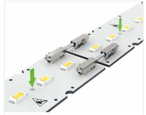
Leiterplatten müssen fixiert werden.
