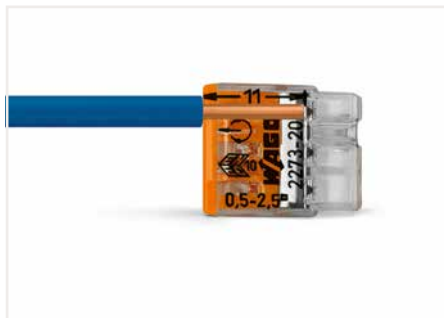
Eindrätigen Leiter gemäß dem aufgedruckten Maß 11 mm abisolieren.
