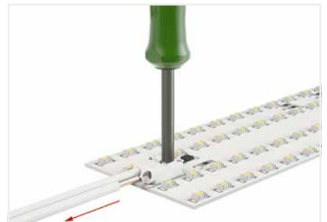
Feindrähtige Leiter anschließen und Leiter lösen – durch geringen Druck auf den Drücker, z. B. mit Betätigungswerkzeug 206-861.
