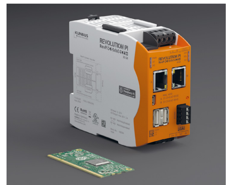
Mit 45 mm ist der RevPi Connect doppelt so breit wie der RevPi Core.
