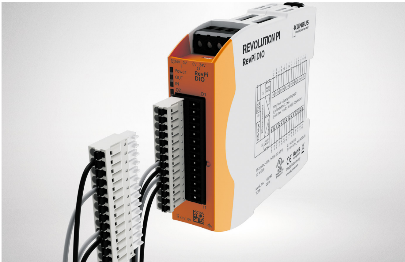
Digitales I/O-Modul RevPi DIO mit 14 digitalen Ein- und Ausgängen.
