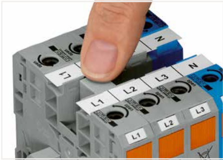
Benachbarte Klemmen können mit Querbrückern in der Klemmenmitte gebrückt werden.
