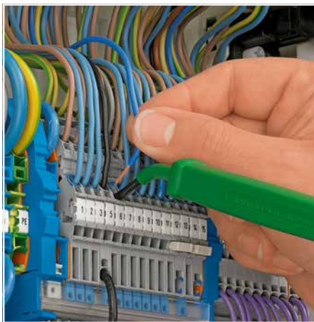
Öffnen der Klemmstelle mit Betätigungswerkzeug
