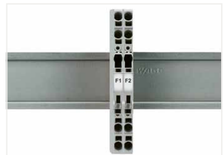
Sicherungsklemmen mit 6,2mm-Klemmenbreite können direkt aneinandergereiht werden. Am Ende der Klemmen- leiste oder, wenn keine Sicherungsklemme folgt, ist eine Endplatte für Sicherungsklemmen zu verwenden.
