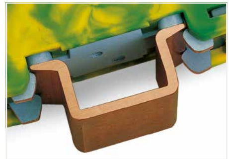
PE-Kontaktfuß PE-Klemmen (gemäß Norm EN 60947-7-2 begrenzt auf max. 120 mm 2 ) müssen zwingend auf eine Kupfertragschiene (2,3 mm dick) aufgerastet werden.
