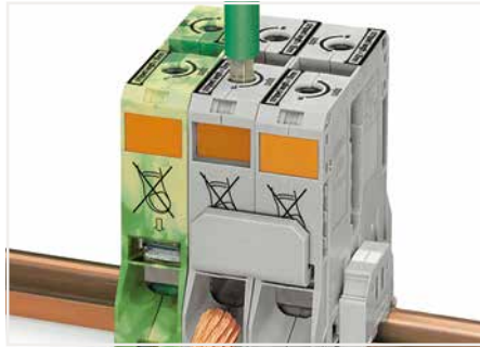
Leiteranschluss – Schritt 2 Abisolierten Leiter bis zum Anschlag in die Klemmstelle führen und in dieser Position halten.
