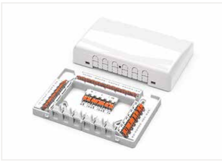
Die Verbindungsdose ist für die Aufputz-Schraubmontage an der Wand/Decke konzipiert. Der Deckel lässt sich schraubenlos aufrasten und lösen. Die Klemmenmontage erfolgt durch intuitives Einrasten und die Montage der Beschriftungsstreifen durch einfaches Einschieben.
