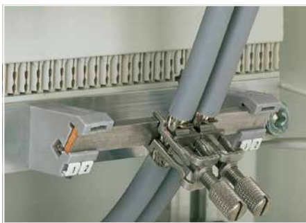
➋ Isolierte Halteblöcke (790-100) für ein gemeinsames Schirmbezugspotential, unabhängig vom Gehäusepotential
