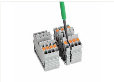
Untereinander verrastete Klemmen werden mit Hilfe eines Betätigungswerkzeugs getrennt und auseinander geschoben.
