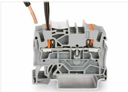
Leiter mit Betätigungswerkzeug anschließen – feindrängige Leiter
