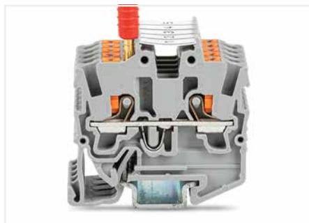
Prüfen mit einem Prüfstecker (210-136) (Ø 2 mm), max. 42 V
