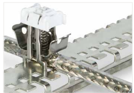
Schirmklemmbügel kontaktiert Schirmleiter und spezialgelochte Tragschiene (790-145). Bitte Distanzstück (790-144) unter der Schiene verwenden.
