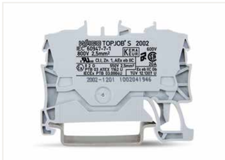
Beschriftungsbeispiel Die Aufschrift auf den Klemmen enthält das Herstellerzeichen, die Seriennummer, die Zündschutzart Ex e II, die Zulassungsnummer, die Zulassungsdaten sowie den Namen des Prüfinstitutes.
