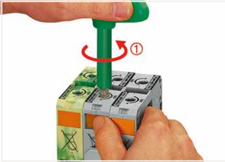
Leiteranschluss – Schritt 1 Innensechskantschlüssel gegen den Uhrzeigersinn bis zum Anschlag drehen ①, dann orangefarbene Taste (Arretierungsfunktion) drücken, Anschlussstelle bleibt geöffnet.
