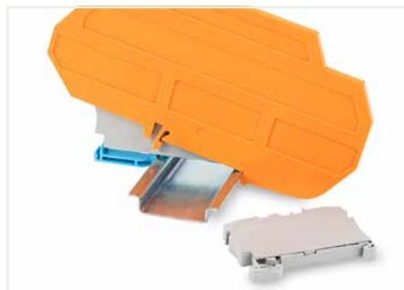
Klemmenleiste Ex e II/Ex i Achtung: Die beweglichen Füße von Klemmen und Trennwand weisen in dieselbe Richtung!
