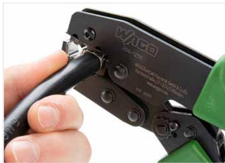
Griffe zusammendrücken, bis die Zwangssperre gegen vorzeitiges Öffnen überwunden ist.
