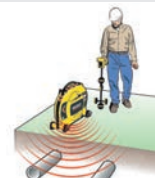
Induzieren eines Signals zur Lokalisierung von Versorgungsleitungen.
