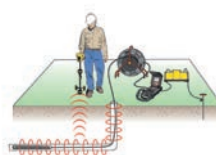
Kunststoffleitungen mit integrierter Leitungssuche auffinden.
