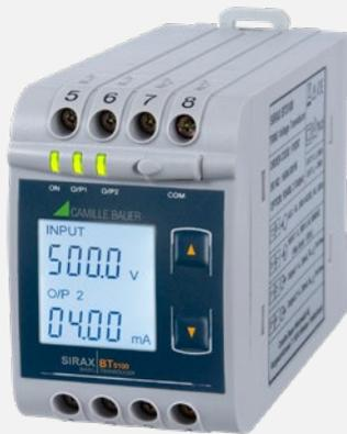
Der Messumformer SIRAX BT5100 ist ein DIN Rail Hutschienengerät das zur Umwandlung einer AC-Eingangsspannung in ein dem Messwert proportionalem DC-Strom- oder Spannungsausgangssignal dient. Die AC-Eingangsspannung und der Ausgangsstrom/ Spannung werden auf dem Display angezeigt und auf der Modbus-Schnittstelle abgebildet.
