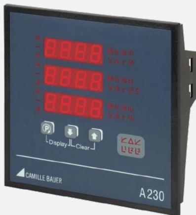
Das Anzeigegerät A230 im Format 144 x 144 x 46 mm ist für den Schaltschrankbau konzipiert. Mit seiner 4-Quadranten-Messung ist es für die Netz- und Verbrauchsanalyse in ein- und mehrphasigen Wechselstromnetzen geeignet.
