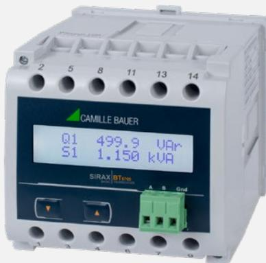
Das universelle Messgerät SIRAX BT5700 ist für Festmontage und die Messung von Spannung, Strom, Frequenz, Leistung, Energie (Wirk-, Blind- und Scheinenergie), Leistungsfaktor, Phasenwinkel, usw. in Niederspannungsschaltanlagen geeignet. Das Gerät ist für asymmetrische Last in Drei-Phasennetzen mit 3- oder 4-Drahtanschluss konstruiert.
