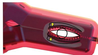
Megger-Klemme wird mit Prüffinger gemäß IEC-Norm auf Kriech und Abstand geprüft.
