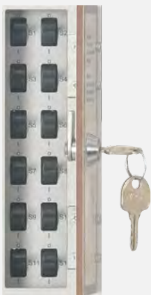
Fehlersimulator mit 12 Fehlermöglichkeiten über Schalter
