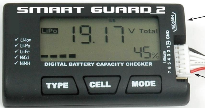
Connecter une batterie de type Ni-Cd ou Ni-Mh
