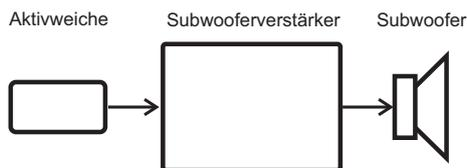
Verbinden Sie die Lautsprecherleitung des Subwoofers mit dem Lautsprecheranschlussterminal am Subwooferverstärker:
