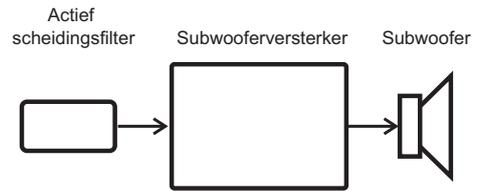
De luidsprekerkabel van de subwoofer met de aansluitsterminal van de luidspreker aan de subwoofer-versterker verbinden:
