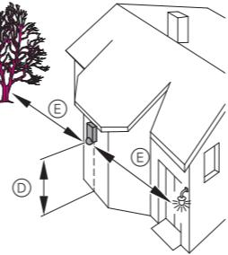
**Montagehöhe D:** 2 - 3 m. Wir empfehlen für die optimale Überwachung eine Höhe von 2,5 m auf festem und ebenem Untergrund.
