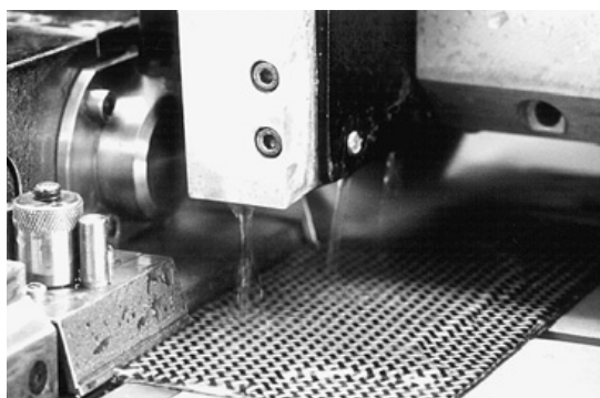
Auch das gehört zu einer modernen Weberei: das Kunststofflabor. Hier werden im Rahmen der Qualitätssicherung Prüflamine hergestellt und die Festigkeit gemessen.
