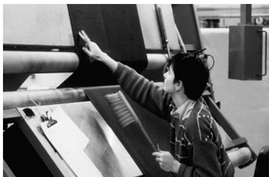
In der Endkontrolle werden die Gewebe kontrolliert, „geputzt“ und gemessen. Abschluß ist das Fehlerprotokoll. Danach erfolgt die Freigabe.
