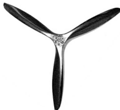
Dreiblatt Luftschraube, mit Kohlerovings verstärkt Three-bladed propeller reinforced with carbon rovings
