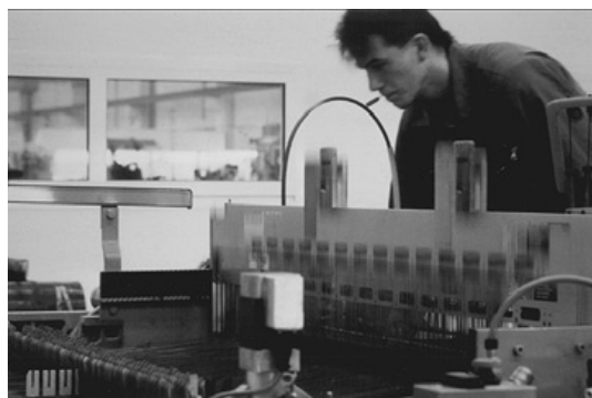
Der Weber kontrolliert die Fertigung. Die Herstellung von Verstärkungsgeweben für die Luft- und Raumfahrt erfordert hochqualifizierte Mitarbeiter.
