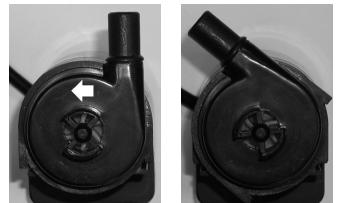
4. Nehmen Sie die Pumpenabdeckung ab und ziehen Sie das Flügelrad heraus, ziehen Sie die Lagerwelle aus dem Flügelrad heraus.
