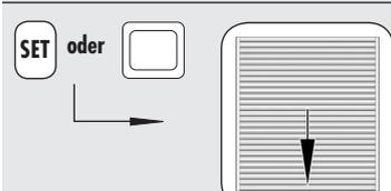
Fahren Sie zum Schluss den Rollladen nach unten (durch kurzes Antippen der SET-Taste oder des externen Tasters).
