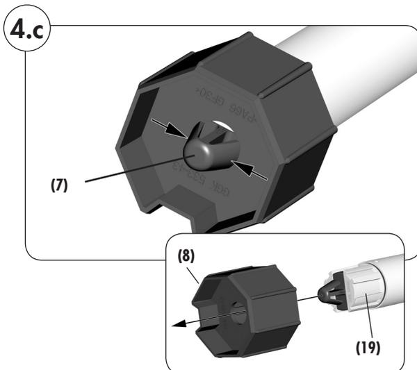
1. Drücken Sie die Seitenteile des Rastbügels (7) zusammen und ziehen die den Mitnehmer (8) vom Abtriebsadapter (19) ab.
