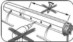
Nie im Bereich des Antriebs bohren oder schrauben, um den Rollladen zu befestigen.
