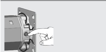
Durch kurzes Tippen der Setztaste (11) können Sie den Endpunkt in kleinen Schritten korrigieren.
