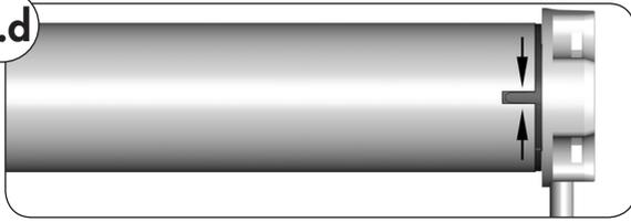
3. Den Rohrmotor in das Präzisionsrohr schieben.
