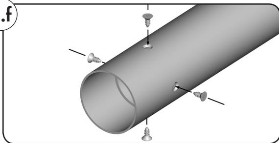
5. Das Präzisionsrohr am Mitnehmer (8) festschrauben oder vernieten. Verwenden Sie vier selbstschneidende Blechschrauben oder vier Blindnieten.
