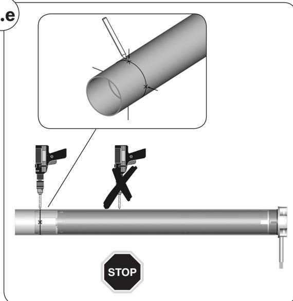
4. Markieren Sie vier Befestigungslöcher und bohren Sie diese anschließend durch das Präzisionsrohr in den Mitnehmer (8).
