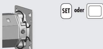
**Die Setztaste (11) am Rohrmotor und die SET-Taste (oder den externen Taster, falls angeschlossen) wieder loslassen.**
