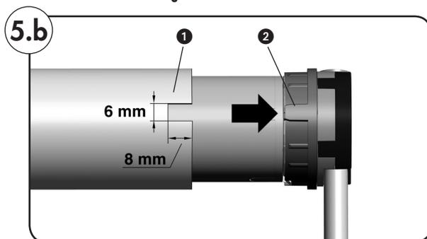
2. **Sägen Sie am Ende des Präzisionsrohrs eine Nut ① aus, damit der Nocken ② des Adapters (10) ganz in das Rohr geschoben werden kann.**
