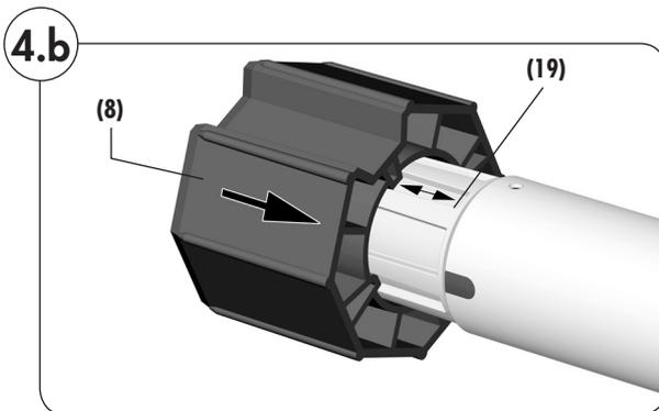
1. Schieben Sie den Mitnehmer (8) so auf den Abtriebsadapter (19), dass er keinen Freilauf hat und hinter dem Rastbügel (7) einrastet.
