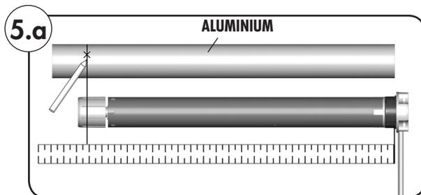
1. **Messen Sie den Abstand zwischen Adapter (10) und dem hinteren Drittel des Mitnehmers (8) und zeichnen Sie diesen Abstand auf das Präzisionsrohr.**
