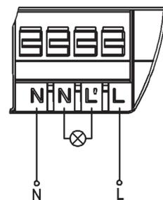
→ Soll die Klemme gelöst werden, so drücken Sie die Verriegelung mit einem geeigneten Schraubendreher ein. Anschließend kann das Kabel wieder herausgezogen werden.
