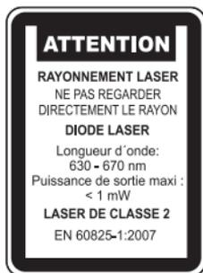
Des panneaux d'information laser en différentes langues sont compris dans l'étendue de la livraison. Si la plaque indicatrice montée sur le laser n'est pas rédigée dans la langue de votre pays, veuillez la remplacer par la plaque correspondante.
