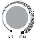
► Aby **zwiększyć** wydajność chłodzenia, przekrącić regulator wydajności chłodzenia zgodnie z ruchem wskazówek zegara.
