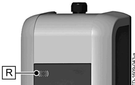
Senzorul RFID [R] servește la autorizarea fără contact a unui utilizator cu carduri MIFARE sau tag-uri conform ISO14443.
