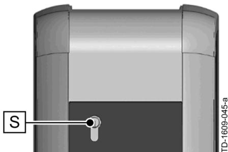
Comutatorul cu cheie [S] servește la autorizarea unui utilizator cu o cheie.
