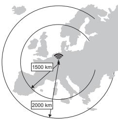
Als het DCF-signalen juist ontvangen werden, zal de weektijdschakelklok een dagelijkse synchronisatie van de tijd doen met behulp van meerdere ontvangstpogingen tijdens de nacht (om 02:00, om 04:00 en om 06:00 uur) omdat er dan de minste ontvangststoringen door andere elektronische/elektronische apparaten zijn.
