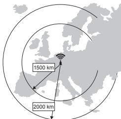
Wurde das DCF-Signal erfolgreich empfangen, nimmt die Wochenzeitschaltuhr eine tägliche Synchronisation der Uhr durch mehrere Empfangsversuche in der Nacht vor (um 2:00, um 04:00 und 06:00 Uhr), da hier Empfangsstörungen durch andere elektrische/elektronische Geräte am Geringsten sind.
