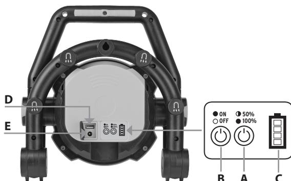
Lai ieslēgtu lampu, nospiediet pogu (B). Nospiežot pogu (A), varat izvēlēties gaismas intensitātes režīmu: 100% vai 50%. Izvēloties pārslēga pozīciju 50%, lampas spīdēšanas ilgums salīdzinājumā ar pārslēga pozīciju 100%, pagarināsies, jo tiek patērēts mazāk enerģijas. Lai izslēgtu lampu, vēlreiz nospiediet pogu (B).
