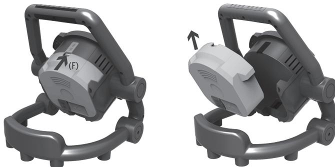
Akumulátor lze snadno a rychle vyměnit. K tomu zatlačte zablokování (F) dopředu a vysuňte akumulátor nahoru, viz kresba. Tak je např. možné nabít akumulátoru a současná práce s náhradním akumulátorem, který lze separátně zakoupit.
