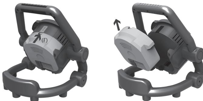
De batterij kan eenvoudig en snel worden vervangen. Druk daartoe de vergrendeling (F) naar voren en schuif de batterij er langs boven uit, zoals afgebeeld. Op deze manier is het bv. mogelijk een batterij op te laden en tegelijkertijd met een apart te kopen hulpbatterij verder te werken.
