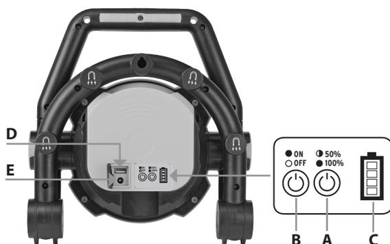
Om de lamp in te schakelen, op knop (B) drukken. Nu kunt u met knop (A) kiezen tussen een helderheid van 100% of 50%. Als u een helderheid van 50% instelt, blijft de lamp langer werken dan bij een helderheid van 100%, omdat minder energie wordt verbruikt. Om de lamp uit te schakelen, drukt u nogmaals op knop (B).
