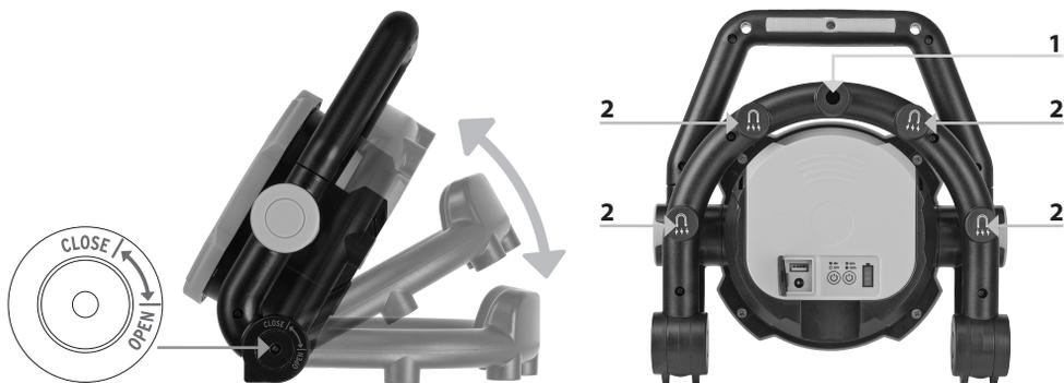
Dans le cadre de l'installation, ce projecteur peut être déplié en plusieurs étapes, au maximum jusqu'à la marque "OPEN". Ne forcez pas pour tenter de déplier davantage le projecteur sous peine d'endommager le mécanisme !
