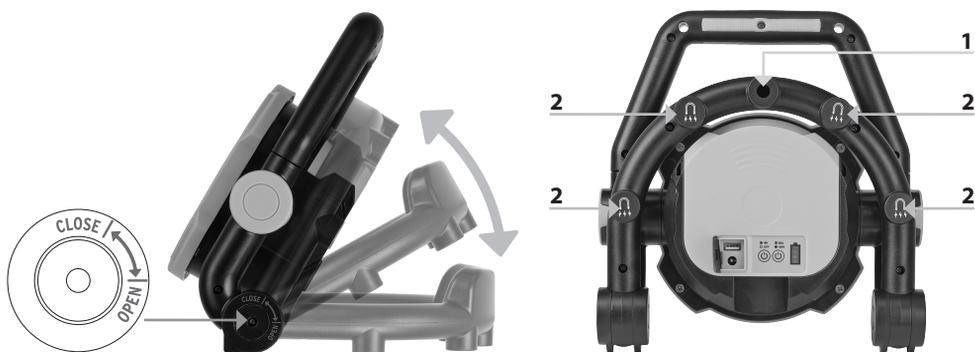
Akkuvalaisin voidaan taittaa useaan asentoon, mutta korkeintaan merkintään OPEN asti. Älä taita valaisinta voimakkein auki, koska sen mekanismi voi vahingoittua sen johdosta! Valaisin voidaan tarvittaessa myös ripustaa rungossa olevan kiinnitysaukon (1) avulla koukkuun tai kiinnittää magneeteilla (2) metallipintaan. Tuotteen vaurioitumisen tai henkilövahinkojen estämiseksi on ehdottomasti varmistettava, että kiinnitys on luja.
