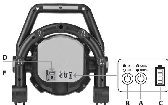
Для включения фонаря нужно привести в действие кнопку (B). После этого с помощью приведения в действие кнопки (A) можно выбрать яркость 100% и яркость 50%. При выборе состояния коммутации 50% длительность свечения по сравнению с состоянием коммутации 100% увеличивается, поскольку в этом случае расходуется меньше энергии. Для выключения нужно еще раз привести в действие кнопку (B).
