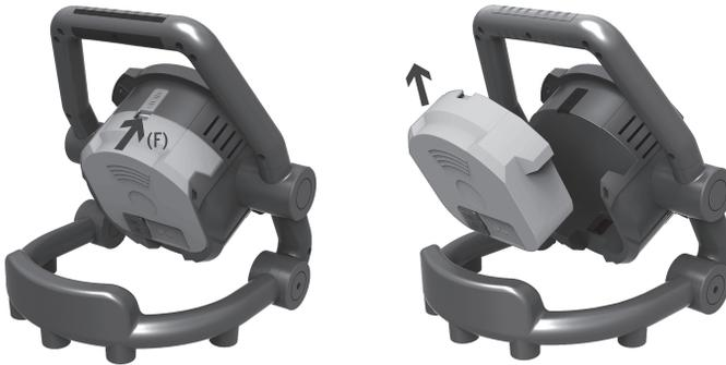
Az akkumulátor könnyen és gyorsan cserélhető. Ehhez húzza előre a záró emeltyűt (F), és emelje ki az akkumulátort (Lásd az ábrát). Külön vásárolható tartalék akkumulátorral folyamatosan üzemelhet.
