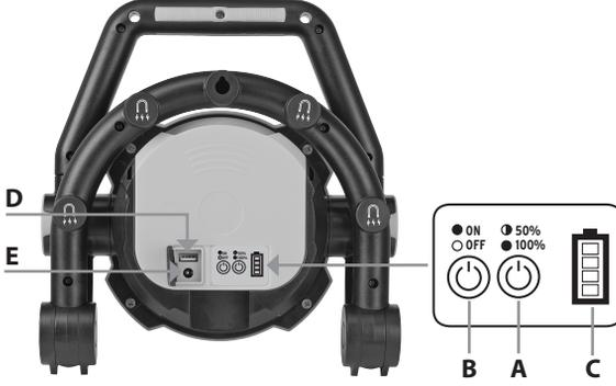
Lambayı açmak için düğmeye (B) basın. Şimdi düğmeye (A) basılarak %100 aydınlık ve %50 aydınlık arasından seçilebilir. %50 anahtarlama durumu seçildiğinde, daha az enerji tüketildiğinden, %100 anahtarlama durumuna karşılık aydınlatma süresi uzar. Kapatmak için düğmeye (B) tekrar basın.
