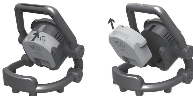
La batería se puede sustituir de manera fácil y rápida. Para ello presione el bloqueo (F) hacia delante y deslice la batería hacia arriba, ver ilustración. De esta manera resulta posible, por ejemplo, cargar una batería y al mismo tiempo trabajar con una batería de repuesto disponible por separado.
