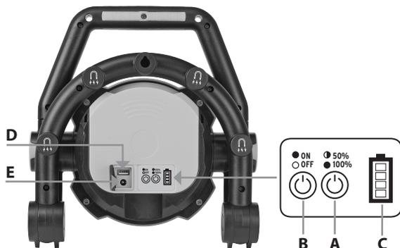
K zapnutí lampy stiskněte tlačítko (B). Pak lze zvolit stisknutím tlačítka (A) mezi 100% jasem a 50% jasem. Při volbě spínacího stavu 50% se prodlouží doba svícení v porovnání se spínacím stavem o 100%, protože se spotřebuje méně energie. K vypnutí stiskněte ještě jednou tlačítko (B).
