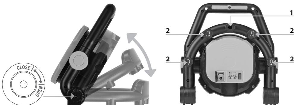
K instalaci lze akumulátorovou lampu rozložit ve více úrovních, ale maximálně po značku „OPEN“. Lampa se dále nemůže rozkládat s použitím násilí, nebo v opačném případě by se mohla poškodit mechanika!
