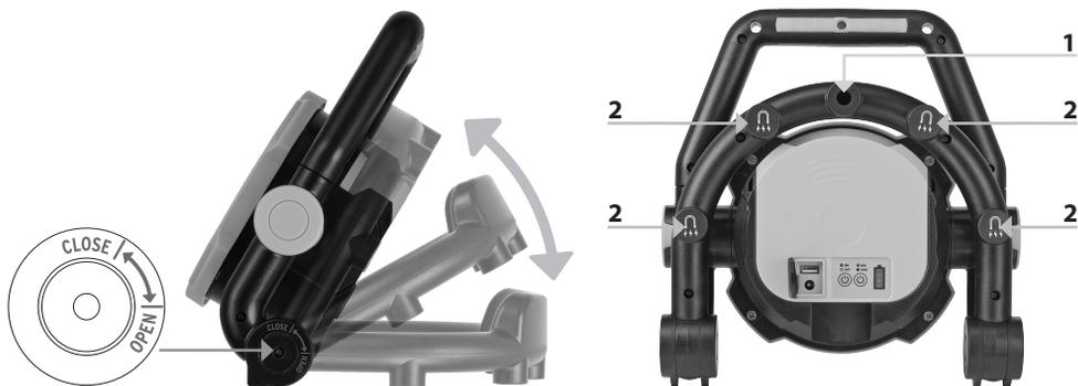
Per il montaggio, la lampada con batteria ricaricabile può essere ripiegata su se stessa a vari livelli, ma al massimo solo fino al contrassegno "OPEN". Non ripiegare ulteriormente la lampada con
