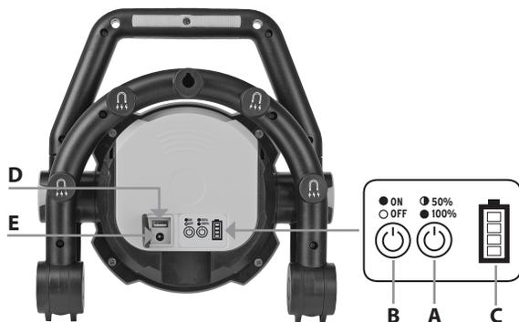
Na zapnutie lampy stlačte tlačidlo (B). Potom sa dá zvoliť stlačením tlačidla (A) medzi 100% jasom a 50% jasom. Pri voľbe spínacieho stavu 50% sa predĺži doba svietenia v porovnaní so spínacím stavom o 100%, pretože sa spotrebuje menej energie. Na vypnutie stlačte ešte raz tlačidlo (B).
