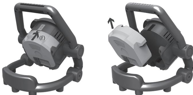
Batteriet kan lätt och snabbt bytas ut. Man trycker låsanordningen (F) framåt och drar ut batteriet uppåt. På så sätt blir det möjligt att t.ex. att ladda upp ett batteri samtidigt som man arbetar vidare med ett separat utbytesbatteri.
