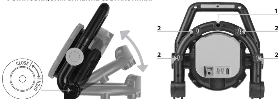
Для выполнения установки светильник с аккумулятором может раскладываться в нескольких уровнях, при этом максимум только до маркировки «OPEN/ОТКР.». Раскладывать светильник дальше с приложением усилия запрещается, поскольку в противном случае будет повреждена механическая конструкция!
