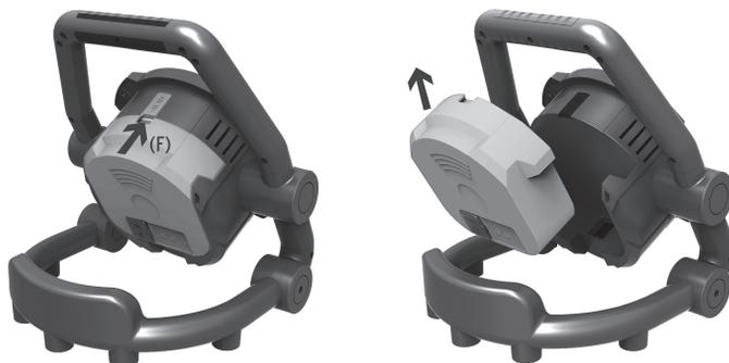
Akumulátor sa dá ľahko a rýchlo vymeniť. K tomu zatlačte zablokovanie (F) dopredu a vysuňte akumulátor hore, pozri kresbu. Tak je napr. možné nabitie akumulátora a súčasná práca s náhradným akumulátorom, ktorý sa dá separátne zakúpiť.
