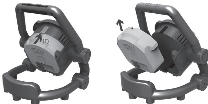
Der Akku kann einfach und schnell ausgetauscht werden. Dazu die Arretierung (F) nach vorne drücken und den Akku nach oben herauschieben, siehe Zeichnung. Somit ist es z.B. möglich, einen Akku aufzuladen und gleichzeitig mit einem separat erhältlichen Ersatzakku weiter zu arbeiten.
