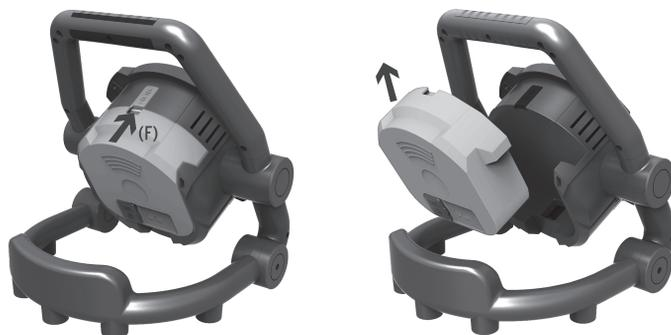
A bateria pode ser substituída com facilidade e rapidez. Para isso, pressionar o trinco (F) para a frente e retirar a bateria deslizando-a para cima. Ver o desenho. Assim, por exemplo, é possível carregar uma bateria e, ao mesmo tempo, continuar o trabalho com uma bateria sobressalente disponível.
