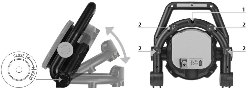
Zum Aufstellen kann die Akku-Leuchte in mehreren Stufen auseinander geklappt werden, aber nur maximal bis zur Markierung „OPEN“. Die Leuchte nicht mit Gewalt weiter auseinander klappen, da die Mechanik ansonsten beschädigt wird!
