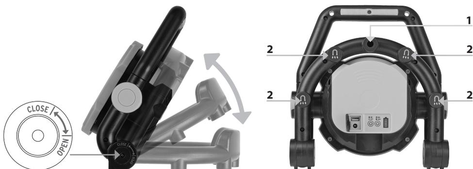
A lámpa tartókerete felállításkor az „OPEN” (Nyitva) jelzésig több fokozatban szényitható. Ne próbálja tovább erőltetni, mert a tartókeret megsérülhet!
