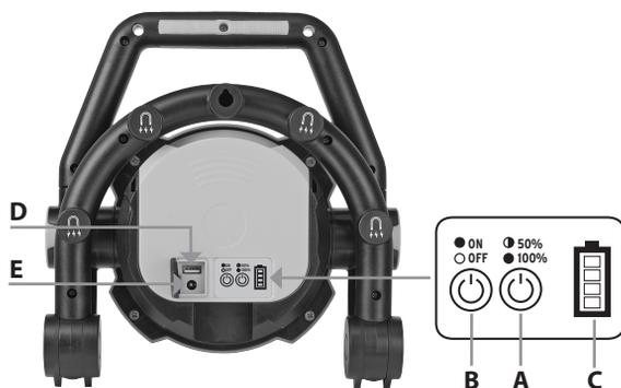
Zum Einschalten der Leuchte den Taster (B) betätigen. Nun kann durch Betätigen des Tasters (A) zwischen 100% Helligkeit und 50% Helligkeit gewählt werden.
