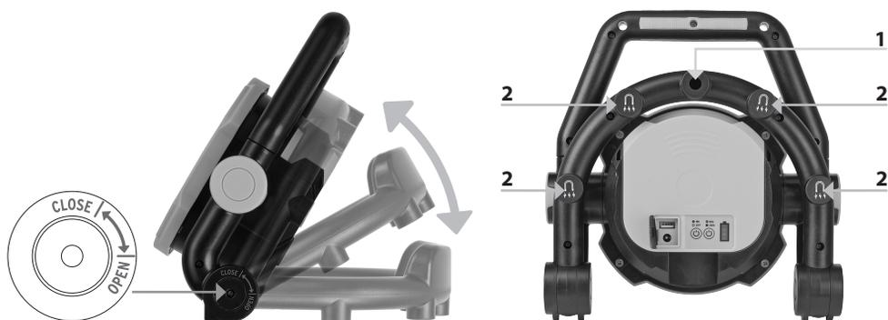
Om de batterijgedreven op te stellen, kan u hem in meerdere trappen openklappen, maar slechts tot de markering "OPEN". Gebruik geen overmachtige kracht om de spot open te klappen, want dat kan het mechanisme beschadigen!
