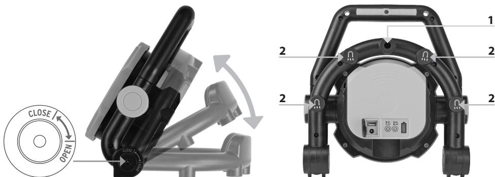
Para el montaje de la lámpara ésta puede plegarse en varios niveles aunque como máximo sólo hasta la marca "OPEN". ¡No fuerce la lámpara si no se puede plegar más, ya que podría dañar su mecánica!
