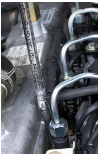
Connexion directe sur l'injecteur
