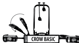
4. Apertura dei binari di sinistra
