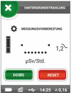
Weiter wird Information über den Zustand der Hintergrundstrahlung auf dem Bildschirm angezeigt.
