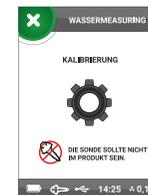
Der Taster wird nun ins Wasser in die angegebene Tiefe eingetaucht, dann muss man abwarten, bis die Temperatur stabilisiert wird (der Wert wird in der oberen rechten Ecke des Bildschirms angezeigt), und dann das Ikon „MESSEN“ auf dem Bildschirm antippen oder die OK-Taste auf dem Gerät drücken.
