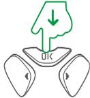
Zum Ausschalten des Geräts wird die Taste „OK“ für 2 Sekunden gedrückt.
