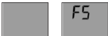
Zobrazení displeje Zobrazení displeje po stisku tlačítka. FS = factory settings (tovární nastavení)
