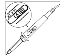
Obr. 1 - 7 Nastavení útlumu na sondě
