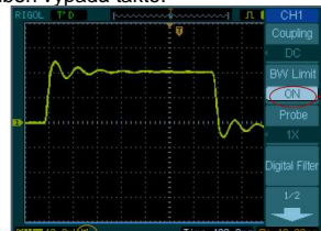
Obr. 2 - 7 Zapnuté omezení šířky pásma
