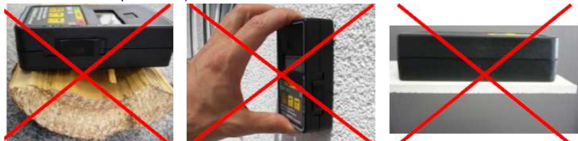
Špatně: nerovný povrch (extrémní příklad)
