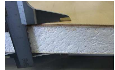
Příklad sendvičové konstrukce: hliník - izolace - překližka
