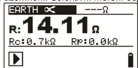
Příklad výsledků pro selektivní měření odporu uzemnění.
