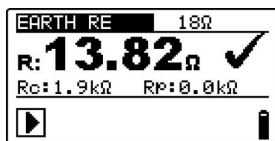
Příklad výsledků měření odporu uzemnění.
