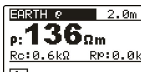
Příklad pro výsledky měření rezistivity půdy.
