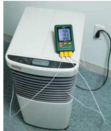
K přístroji připojené termočlánky typu „K“ nelze použít k měření teploty objektů pod napětím. Mohlo by to způsobit zničení měřícího přístroje. Rozhodující při měření teploty je, aby nebyl měřící přístroj vystaven teplotám, které chcete změřit. Těmto teplotám může být vystaven pouze hrot senzoru (termočlánku) na měření teploty.
