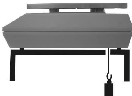
Obrázek 1: Příprava vah pro podlažní vážení
