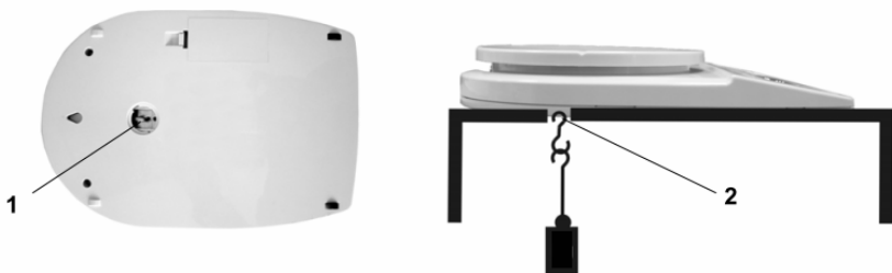
Obr. 1 Příprava váhy pro závěsné vážení.
