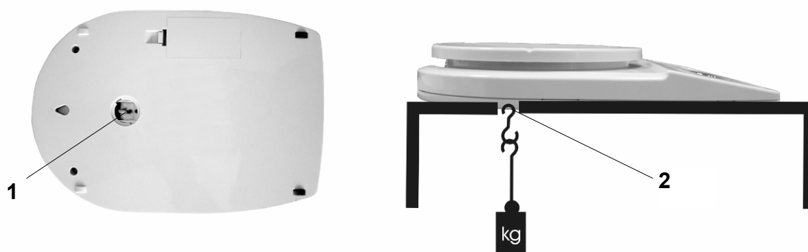
Výkres 1: Postavení váhy k vážení pod podlahou
