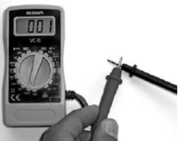
Obr. 50: Pokud se při měření impedance spojí sondy obou měřících kabelů, bude multimetr ukazovat 0,0 nebo 0,01 \Omega . Znamená to, že vodič je průchodný.
