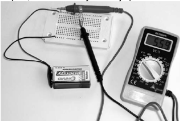
Obr. 45: Na rezistoru (1 kΩ) došlo k poklesu napětí 5,59 V. Aby se dosáhlo co nejpřesnějšího měření napětí, nastavte vždy ten nejlepší rozsah měření.
