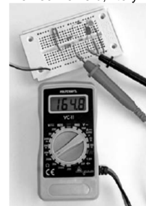
Obr. 72: Druhou možností je funkce testu diody na multimetru Voltcraft VC-11. Pokud se zobrazuje naměřená hodnota, dioda se měří v směru, kterým propouští proud.
