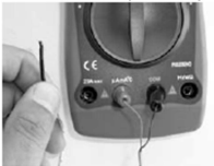
Obr. 80: Měření teploty vzduchu v blízkosti halogenové lampy. Vysoké teplotě se smí vystavit jen hrot teplotního senzoru.
