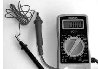
Obr. 52: Určení průchodnosti vodiče v kabelu
