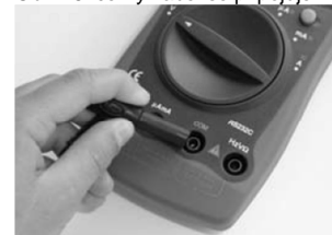
Obr. 18: černý kabel se připojuje ke zdířce COM. Odpovídá zpětnému proudu (záporný pól)
