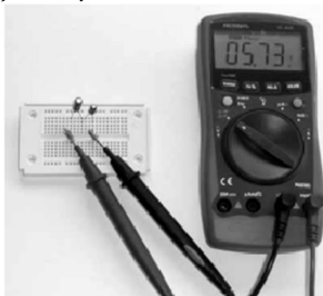
Obr. 38: Když se dva kondenzátory s kapacitou 10 \mu\text{F} připojí sériově, naměříte poloviční hodnotu jednotlivých kondenzátorů.
