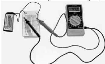
Obr. 66: Jalové napětí této baterie je 9,6 V
