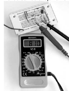
Obr. 72: Druhou možností je funkce testu diody na multimetru Voltcraft VC-11. Pokud se zobrazuje naměřená hodnota, dioda se měří v směru, kterým propouští proud.
