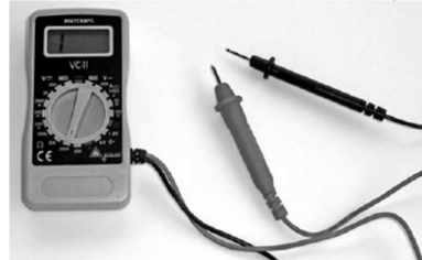
Obr. 51: Oddělením obou měřících sond dojde ke zvýšení impedance a multimetr začne ukazovat „1-“. Znamená to, že vodič není průchodný nebo že je přerušeny.
