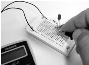
Obr. 49: Multimetrem protéká stejný proud jako jinými spotřebiči v obvodu.
