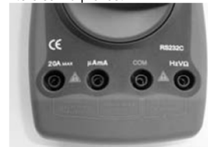
Obr. 18: černý kabel se připojuje ke zdířce COM. Odpovídá zpětnému proudu (záporný pól)
