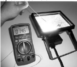
Obr. 80: Měření teploty vzduchu v blízkosti halogenové lampy. Vysoké teplotě se smí vystavit jen hrot teplotního senzoru.
