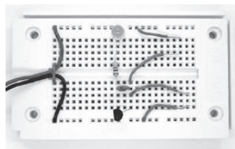
Obr. 41: Nastavitelný jas diody
