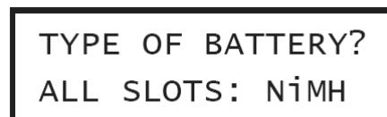
Během dalších 5 sekund zvolte stisknutím tlačítka „<“ nebo tlačítka „>“ typ akumulátorů „NiMH“ nebo „NiZn“ a potvrďte toto nastavení stisknutím tlačítka „OK“. Budete-li nabíjet akumulátory NiCd, pak zvolte nabídku „NiMH“. Akumulátory NiCd a NiMH můžete v této nabíječce nabíjet společně.
