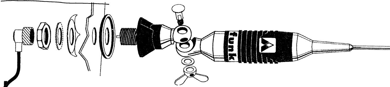
Širokopásmová výkonová mobilní anténa pro SB se snadnou montáží. Instalace DV, prům. 12 mm.
