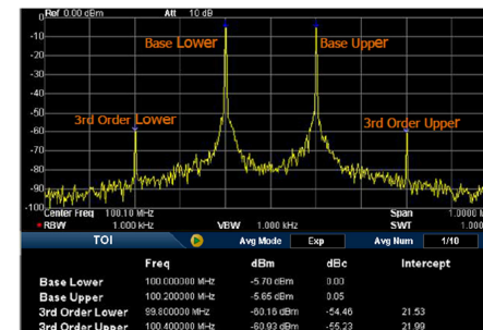
Obr. 2 – 16 Rozhraní měření TOI
