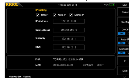
Obr. 2 – 24 Nastavení parametrů LAN
