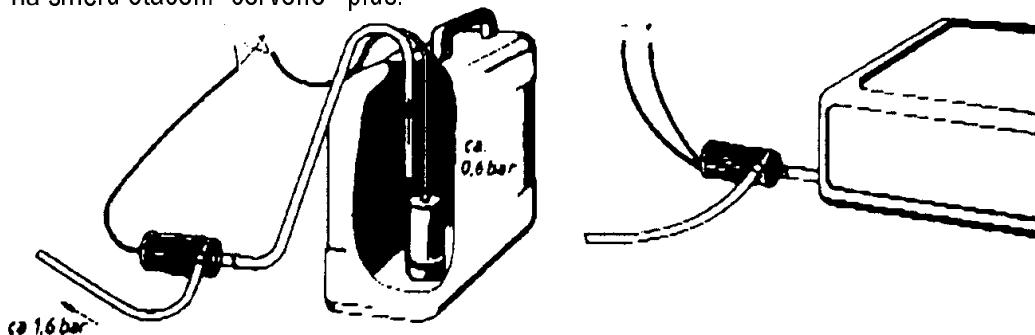
Zabudování mimo vodní tank nebo jako posilovací čerpadlo.
