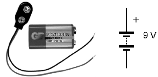
Baterie 9 V a její schématická značka
