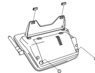
Instalace gumových podložek
