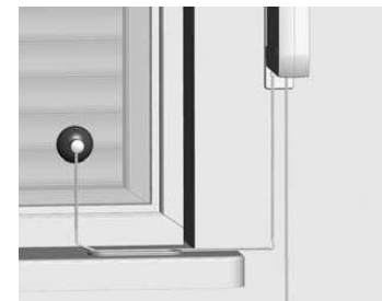
Příklad instalace slunečního senzoru.
