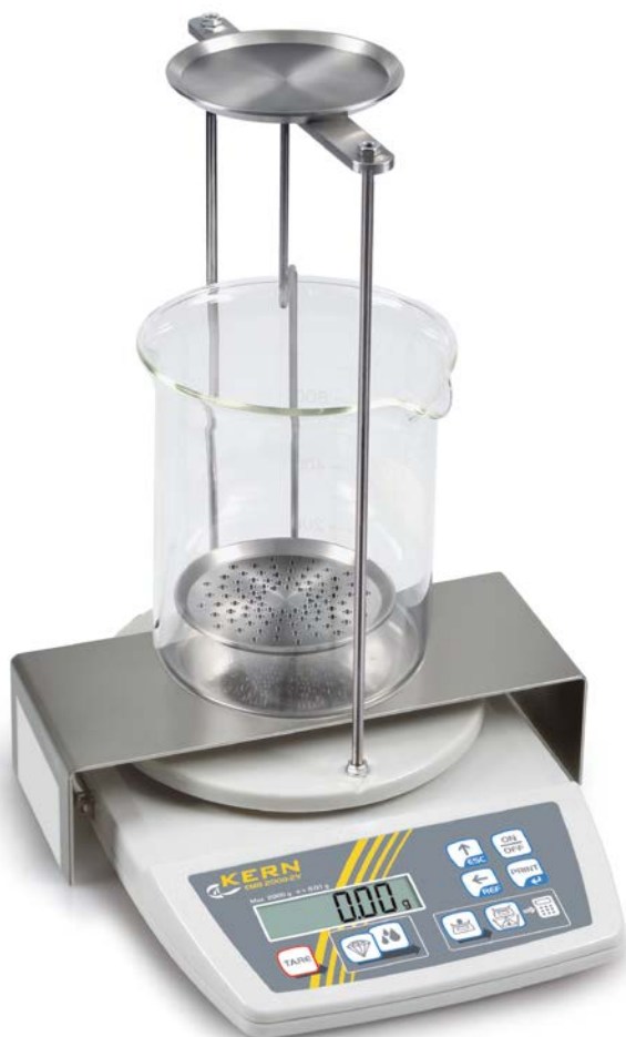
Obr. 1: Váha KERN EMB 2000-2V s namontovanou sadou ke stanovení hustoty KERN YDB-02(číslování viz část 1)
