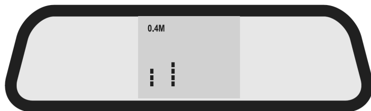
Překážka na levé straně vozidla ve vzdálenosti 0,4 m (40 cm)
