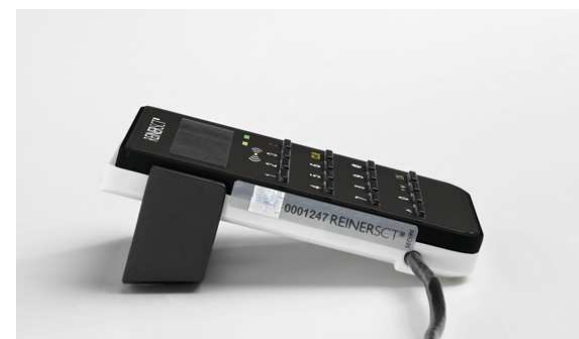
Umístění bezpečnostní plomby na levé straně cyberJack® RFID standard .
