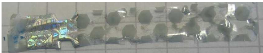
Narušená a poškozená bezpečnostní plomba.
