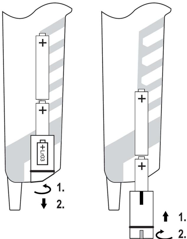
Otočte vhodným plochým šroubovákem nebo malou mincí (nebo jiným vhodným nástrojem) uzávěr bateriového pouzdra na spodní straně zkoušečky o 90 ° směrem doleva (viz vyobrazení výše vlevo) a poté vysuňte ze zkoušečky uzávěr bateriového pouzdra.
