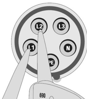
Přiložte oba měřicí hroty k měřenému objektu (zastrčte je do zdířek síťové trojfázové zásuvky, přiložte je ke kontaktům elektrických přístrojů, například ke kontaktům třífázového motoru atd.).
