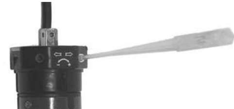
Šroubky a nástroj pro seřízení koncových poloh
