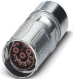
Kabelový zástrčkový spoj, přímý, Zajištění SPEEDCON, M17, Počet pólů: 17, Druh kontaktu: Zásuvka, Lisovaný spoj, stíněná: ano, Průměr kabelu: 9 mm...11 mm
